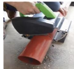
1、精確管道切割管鋸：管道鋸確保精確、快速和安全的切割，不會產生飛濺的火花和熱碎片。
