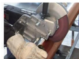
2、帶夾緊裝置的切割器也能在沒有飛濺火花的情況下取得很好的效果。
